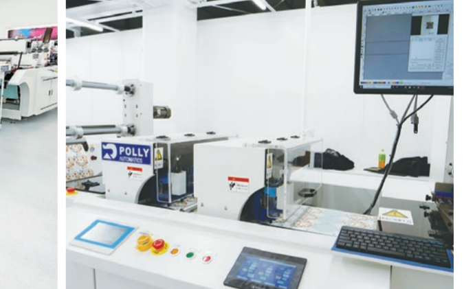
国内累計100台以上の導入を誇る水性IJ方式「SurePress L-4733AW」。課題の後加工も高速カッティングプロッターの接続で解決
