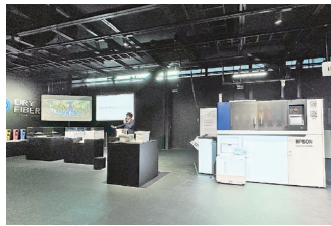
オフィスでも、使用済み用紙を再生紙へ転換できる「PaperLab」
